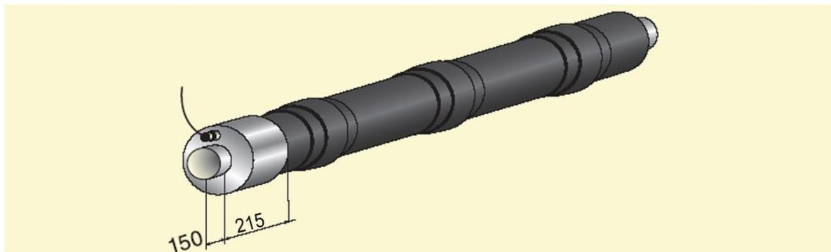
**Пример заказной спецификации** стальной трубы наружным диаметром 426 мм, толщиной стенки 7 мм, с изоляцией типа 1 из пенополиуретана с усиленной полиэтиленовой оболочкой, с металлической заглушкой изоляции длиной 215 мм и кабелем вывода: труба с усиленной оболочкой и металлической заглушкой изоляции и кабелем вывода Ст 426x7-1-ППУ-ПЭ-Б-215К. ГОСТ 30732.
